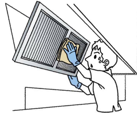
グリスフィルターの清掃
